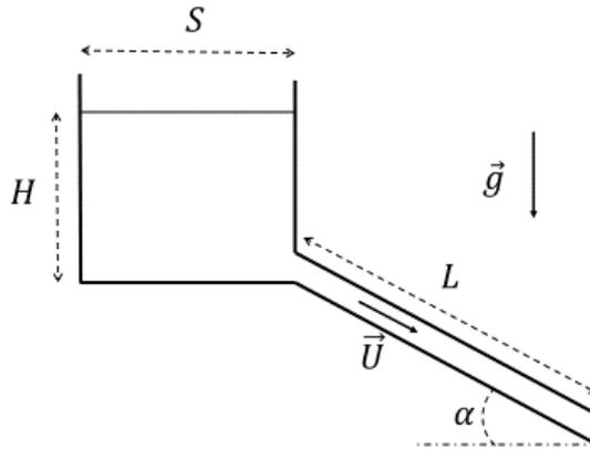
On cherche à déterminer le débit de volume  $Q$  et la vitesse débitante en sortie de la conduite. Les pertes de charge sont les suivantes :
