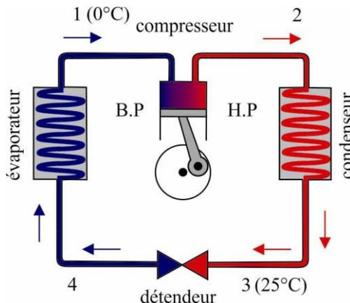
On considère une installation frigorifique développant une puissance frigorifique de 100 kW. Le fluide frigorigène est l'ammoniac (réfrigérant R717 dont on donne le diagramme  $(P, h)$  en annexe). Il subit :
