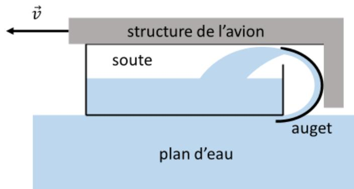
Le remplissage d'une soute se fait par l'intermédiaire d'un auget orienté dans le sens du déplacement de l'avion, qui renvoie les veines d'eau dans le sens opposé à la direction du jet incident. La section droite du jet d'entrée est égale à la section  $s_a$  d'une écope. La hauteur de l'auget (son diamètre) est de 50 cm.
