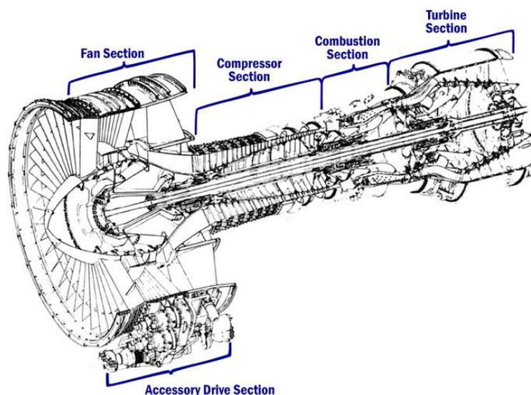
Un turboréacteur tel que le General Electric CF6-6 représenté ci-dessus est schématisé de la façon suivante :
