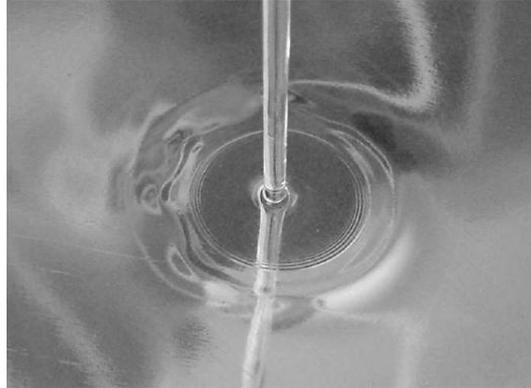
On note  $D$  le débit de masse de l'eau sortant de la burette et  $\mu$  la masse volumique de l'eau. A la distance  $r$  de l'axe,  $a \leq r \leq b$ , on note  $h(r)$  la hauteur d'eau et  $\vec{v}(r) = v(r)\vec{u}_r$  la vitesse du fluide, supposée quasi-radiale.
