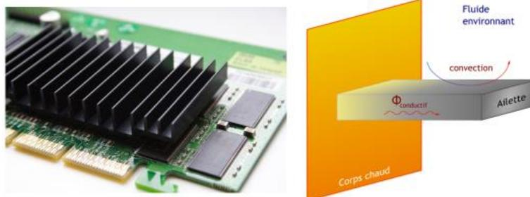
Pour éviter un échauffement trop important de certains appareils et évacuer la chaleur vers l'atmosphère, on a souvent recours à un dispositif (radiateur) constitué d'ailettes de refroidissement, que l'on fixe à l'appareil que l'on souhaite refroidir. Dans cet exercice, on étudie une unique ailette de refroidissement constituée d'un matériau métallique (M) de conductivité thermique  $\lambda$ , de section
