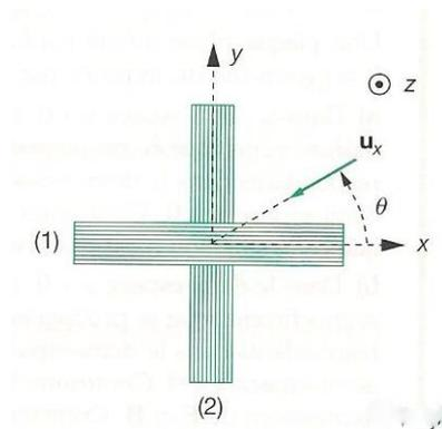
Lorsque l'antenne reçoit une onde électromagnétique PPH se propageant selon la direction  $\vec{u}_x$  du plan horizontal, repérée par l'angle  $\theta$ , il apparaît aux bornes des bobines deux tensions  $e_1(t)$  et  $e_2(t)$ .
