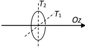
1) Une onde électromagnétique plane, polarisée rectilignement, arrive normalement sur le polariseur. Le vecteur champ électrique de l'onde fait un angle  $\vartheta$  avec la direction de transmission privilégiée du polariseur, supposée parallèle à l'axe  $Ox$ . Calculer le coefficient de transmission  $T$  en énergie de l'onde à travers le polariseur en fonction de  $T_1$ ,  $T_2$  et  $\vartheta$ . Commenter en envisageant le cas du polariseur idéal.
